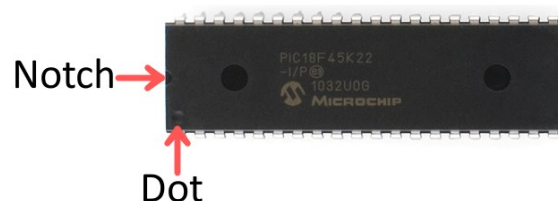
Označavanje polariteta i numeriranje pinova
